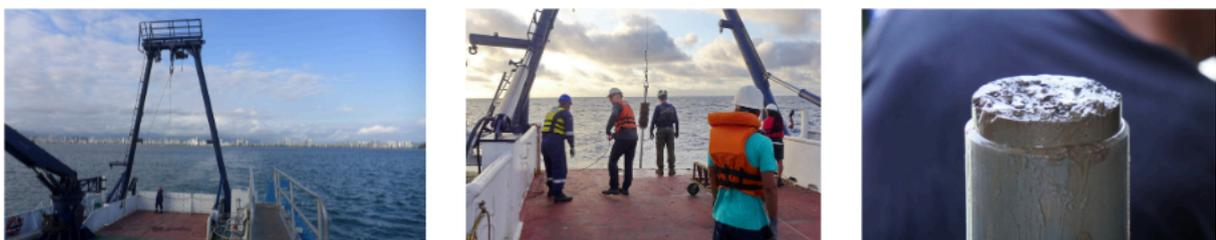
Figura 3: Em alto mar, o lançamento de instrumentos e a obtenção de testemunho do fundo marinho
