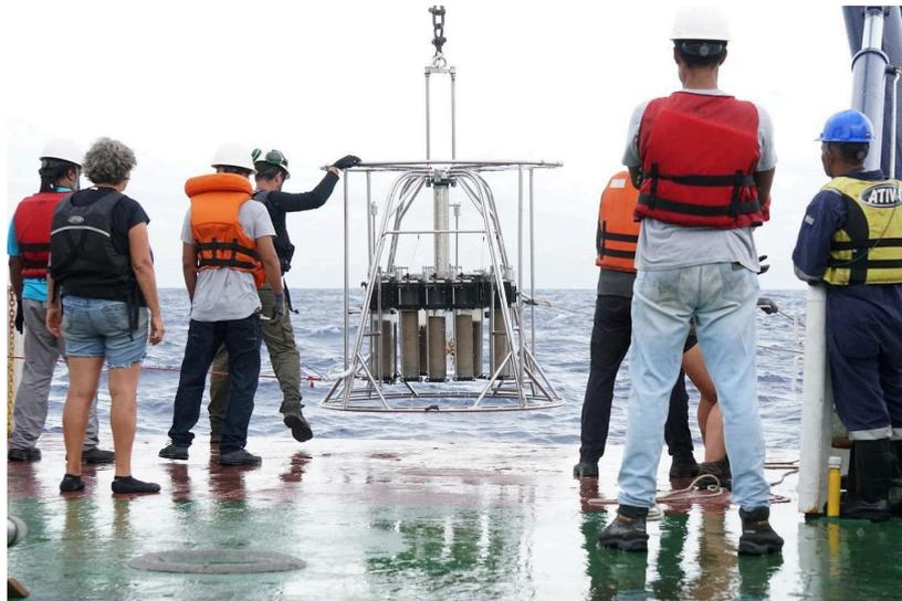
Figura 5: Multiple-corer lançado desde o navio oceanográfico R/V. Alpha Crucis
